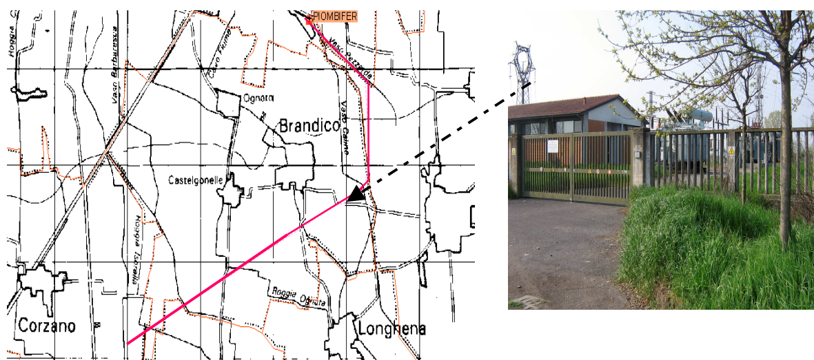
In viola, tracciato dell'elettrodotto da 130 kV e, a destra, particolare della cabina primaria Enel di trasformazione A/M
